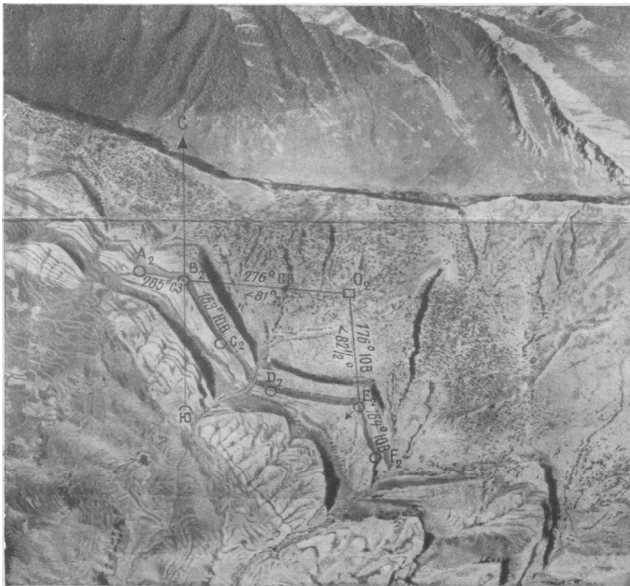
Рис.7.4. Лівий (а) і правий (б) АФЗ: А, В, С – точки на виході пласта; О – головна точка аерофотознімку
