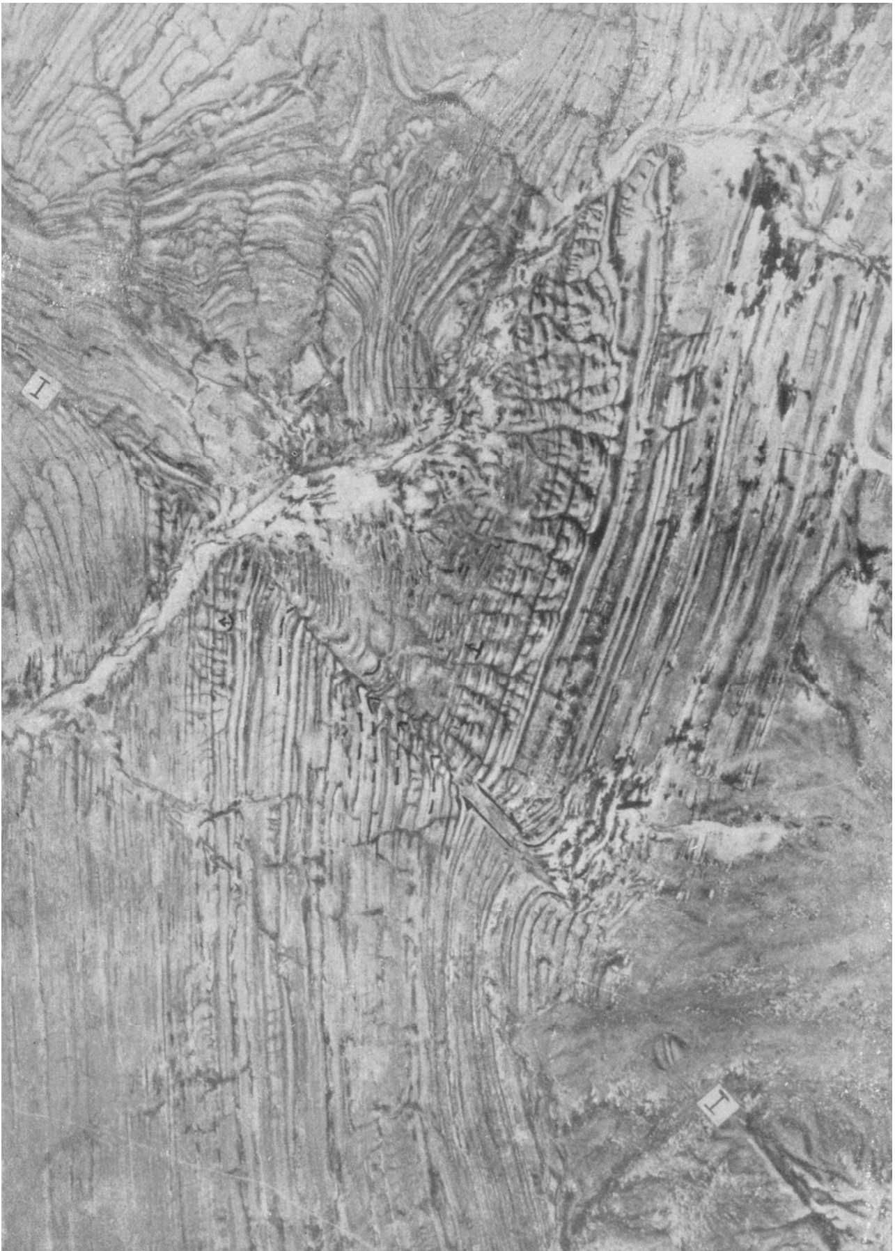
Рис. 9.1. Зсув серед дислокованих порід. Згини шарів біля лінії порушення вказують на напрям переміщення
