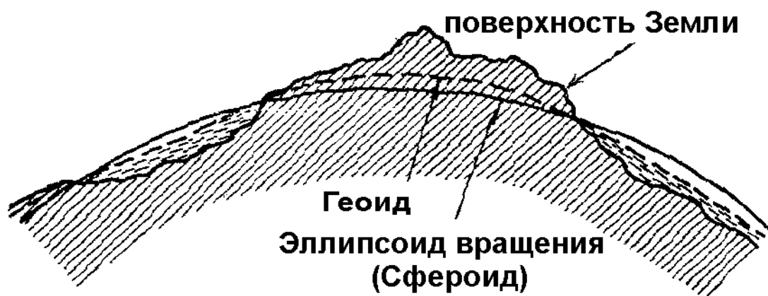
Рис. 2.2. Соотношение поверхностей геоида, эллипсоида вращения и топографической поверхности (рельефа) в вертикальном разрезе
