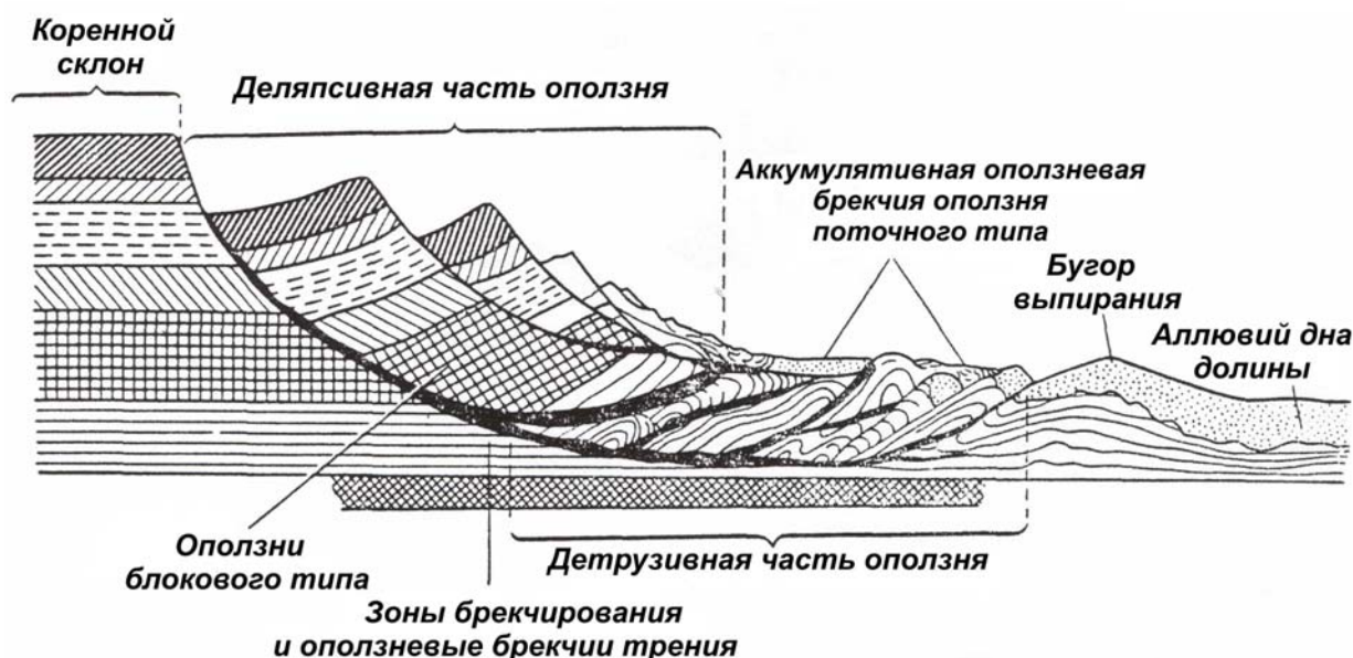
Рис. 5.15. Схема сложного оползня (по Е.В. Шанцеру)
