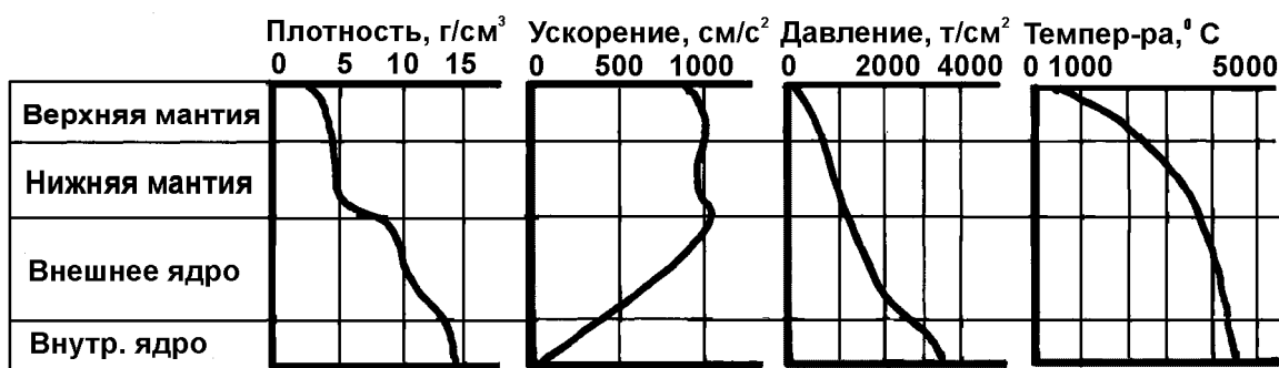
Рис. 1.2. Характер изменений показателей плотности вещества, ускорения свободного падения, давления и температуры внутри Земли
