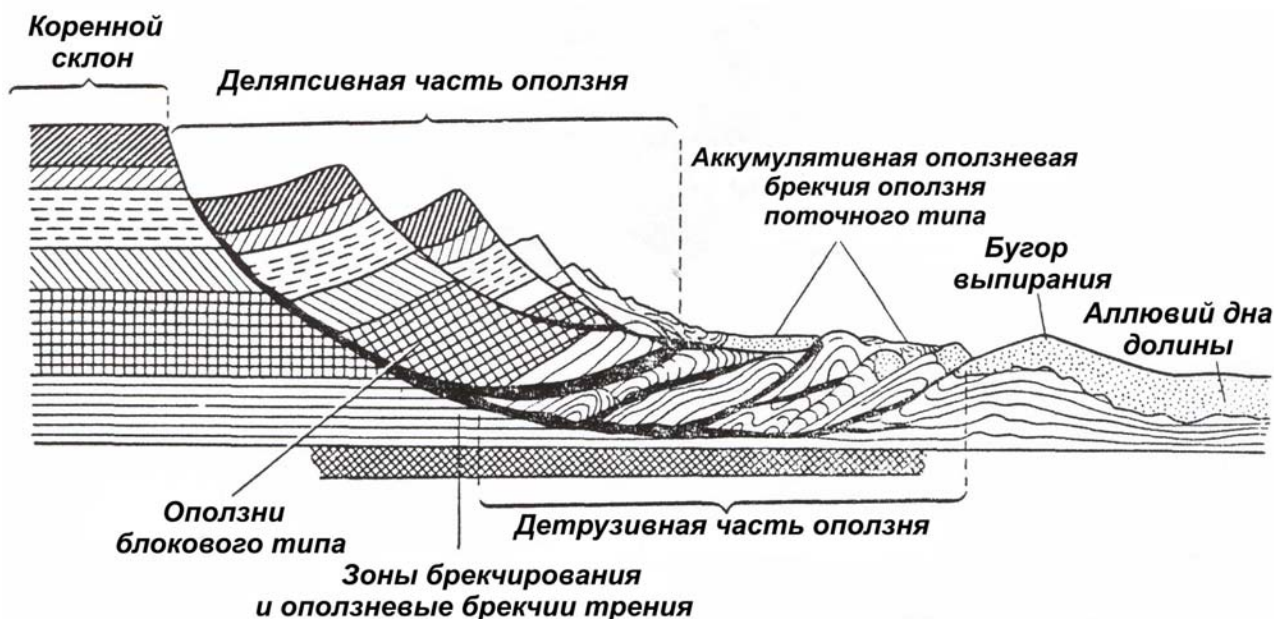
Рис. 4.33. Схема сложного оползня (по Е.В. Шанцеру)
