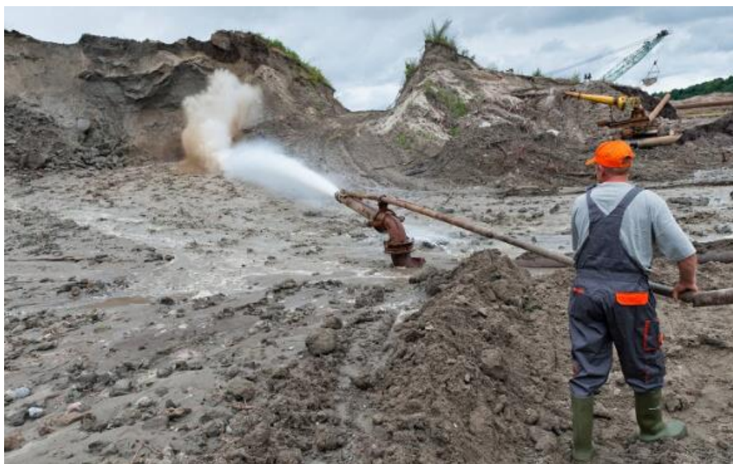
Рис. 2.26. Видобуток бурштину за допомогою гідромоніторів на кар'єрі Пальмнікенського родовища, Росія ( https://kaliningrad.rbc.ru/kaliningrad/freenews/5a1025499a7947fc82879fad )
