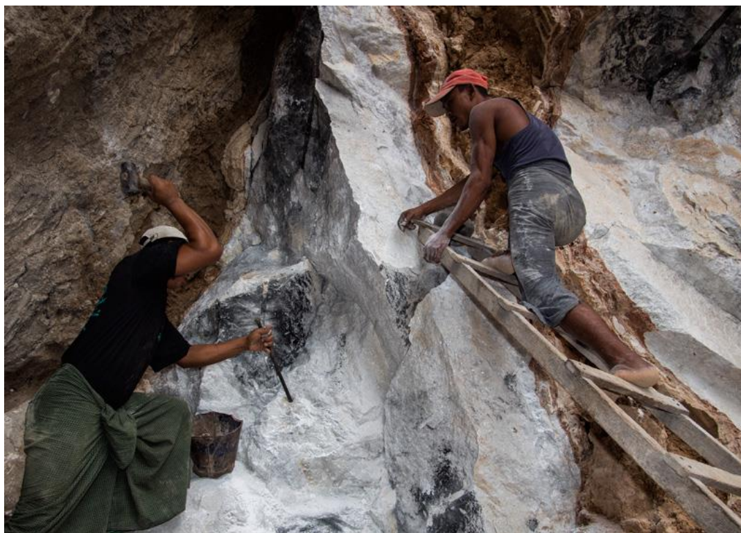
Рис. 2.8. Закладка вибухівки до рубіноносного мармуру. Субвертикальна жила глинистих порід могла слугувати джерелом Al і Cr, необхідних для виникнення рубіну (фото: Е. Біллі Хьюз)
